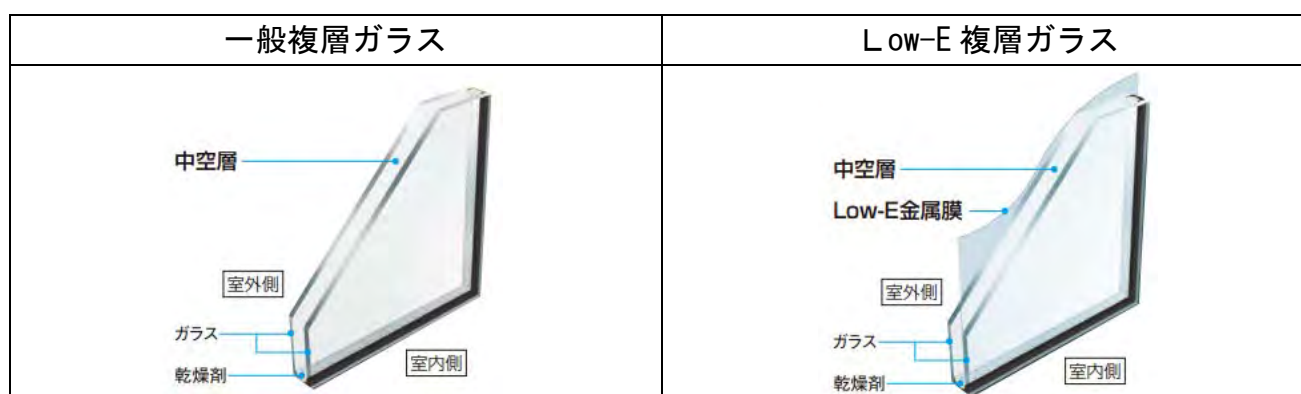
図3：複層ガラスの構造
