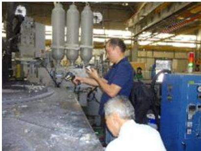
電気炉炉壁温度測定
