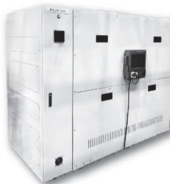
写真-1 オンサイト型エキシマレーザ用 Ne ガスリサイクル装置
