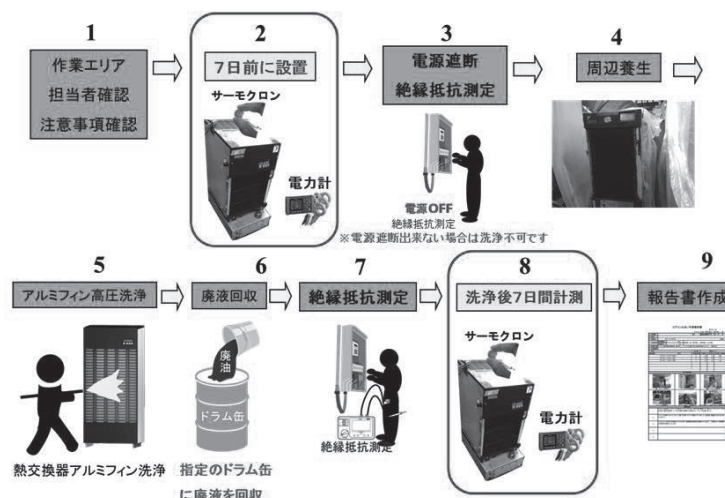
図-5 エアマルプランのフローチャート（オイルクーラー洗浄・省エネ計測）
