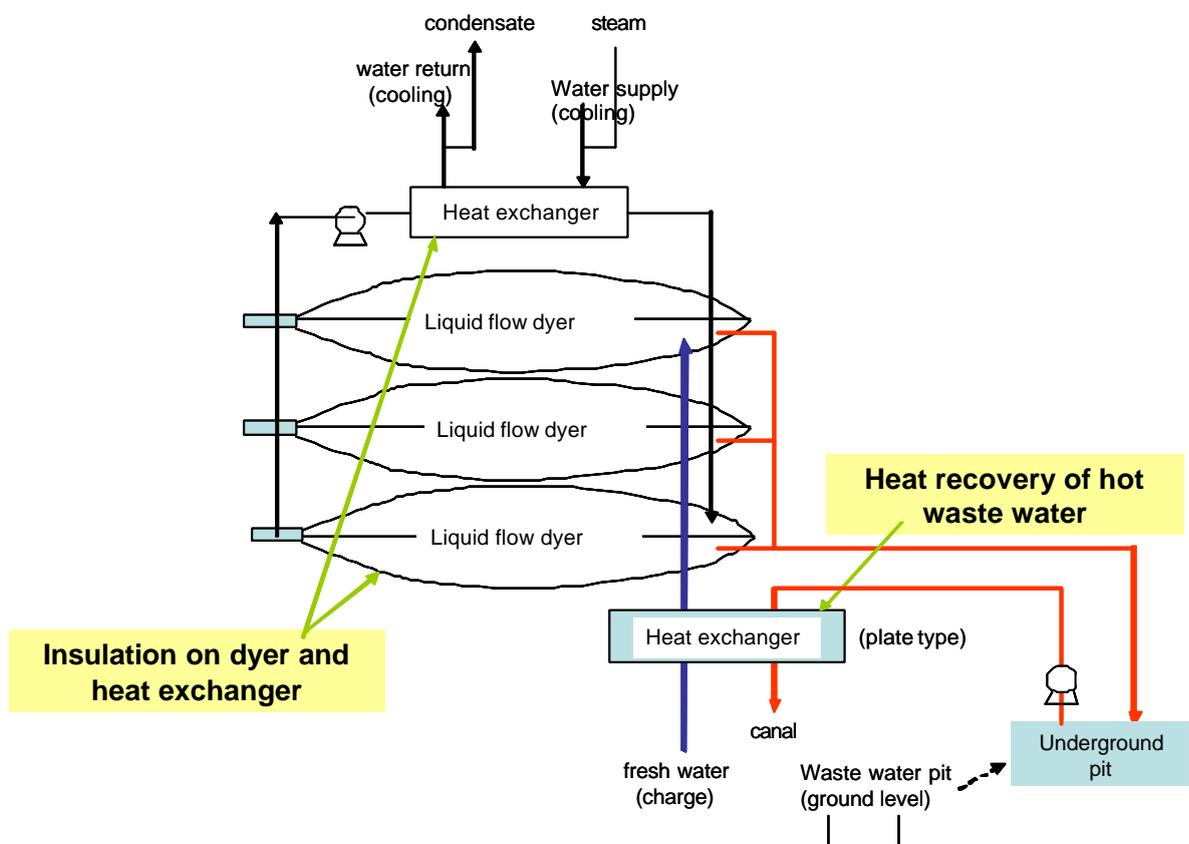
染色機は1サイクル11時間、1日に2サイクルのバッチにて運転される。布処理量は1サイクル800kgである。布1kgあたりに10kgの染色液または洗浄水を使用する(液比10と呼ぶ)。1サイクルの間に染色・中和・洗浄が図9-2のレシピに従って繰り返される。
