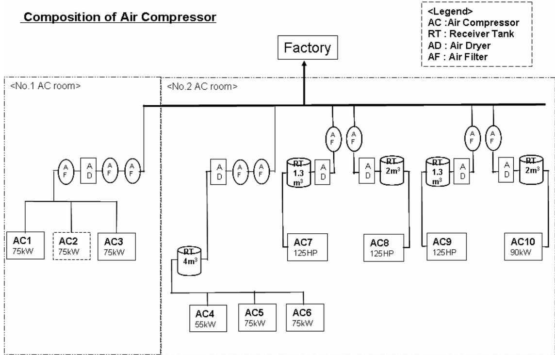
エアコンプレッサーは合計 9 台が設置されており共通のエア本管へ全数接続されている。空冷式(AC1~AC3)は上部吸込み / 前面排気(室外へ)であり、他機とは別の部屋に設置されている。水冷式(AC4~AC10)は送水ポンプ(22kW, AC10 : 3.7kW)を装備している。
