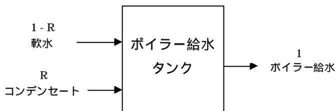
コンデンセートにはクリーンとダーティーがある。クリーンとは間接加熱用に使用した蒸気から生じたコンデンセートであり、ボイラー給水タンクへの回収の対象になる。
