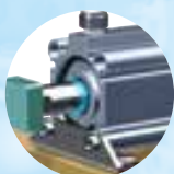
パッキン/摩耗によるシリンダからの漏れ
