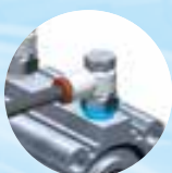
配管施工不良による配管接続部漏れ
