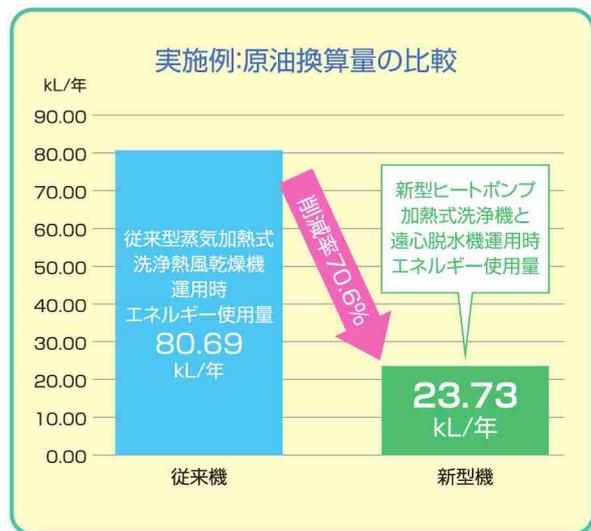
**従来型** 約60℃に加温された温水により洗浄・すすぎを、約120℃に加温された熱風で容器を乾燥させます。
