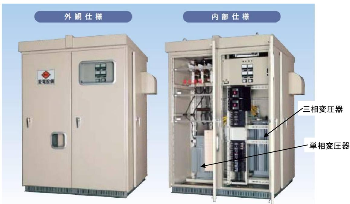
キュービクル式高圧受電設備は変圧器、開閉器、計測器、保護装置を内蔵した配電盤です。その内変圧器は動力負荷用の三相変圧器と照明・コンセント負荷用の単相変圧器2台を収納しています。主要な用途は小規模工場、店舗、公共設備(学校、公民館)、小規模ビルの電源設備です。
