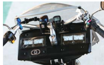
発電量を計測するメーター
