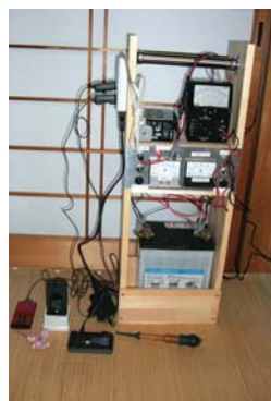
自作のソーラーバッテリー、BOX(仮称)で、バッテリー、携帯電話、デジカメを充電
